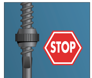
Borging door stelmoer: werkt als stop.
