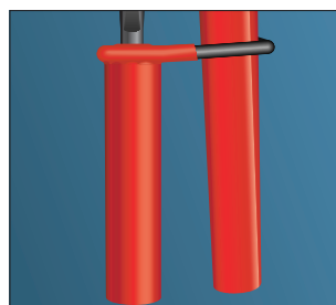
De pijptangvergrendeling vergrendelt de pijptang in de gespannen positie en zorgt voor een "extra" hand.
