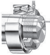
Bild 3. Einbau eines Lagers direkt auf kegeligem Sitz
